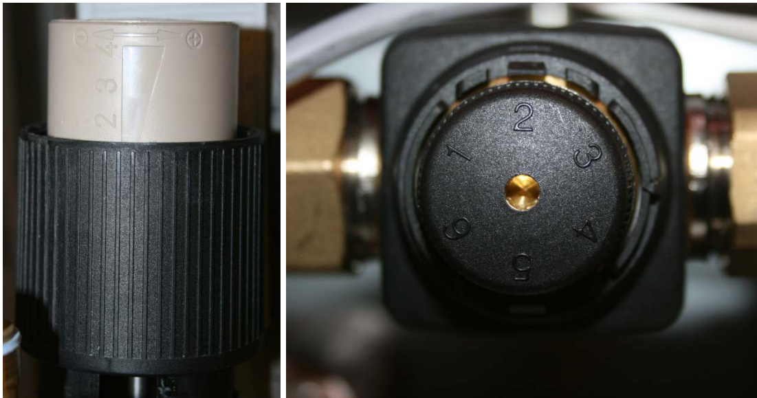
Figur 2. Varmvattenregulatorns (vänster) samt temperaturbegränsarens (höger) inställningar för dynamisk provning.
